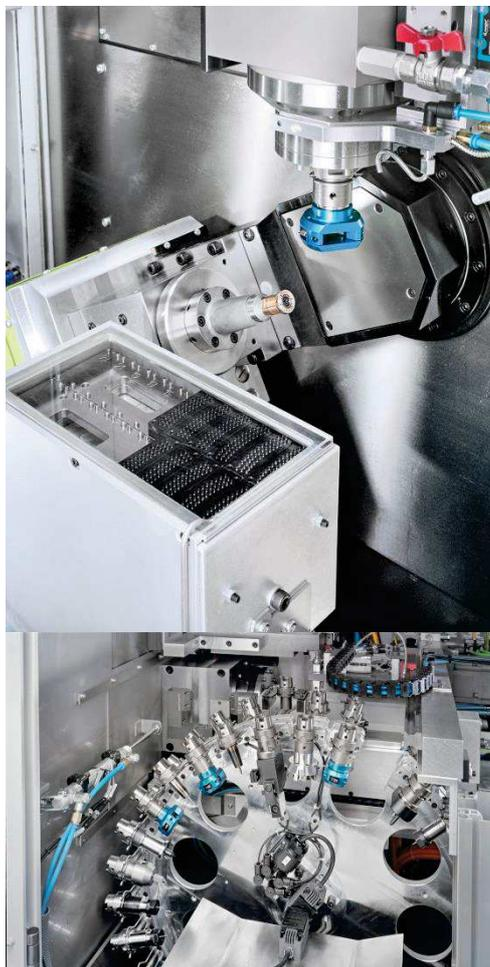
Ce centre de fraiseage à 5 axes, offre, dû à sa conception et sa configuration des axes, plusieurs libertés et possibilités, qui ne sont pas réalisables avec des centres de fraiseage conventionnels. N'importe si des bagues, bracelets, le bijou ou des pièces de l'horlogerie, les surfaces sont fraisés aux diamants, gravés, guillochés, facettés etc. En liaison avec notre machine FourC, on peut faire aussi le sertissage des pierres entièrement automatisés.
